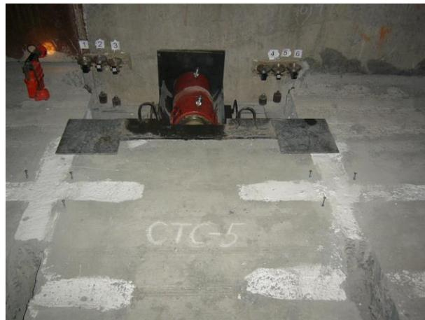
Рисунок 6 – Схема и стенд для испытаний продольного стыка на сдвиг:
