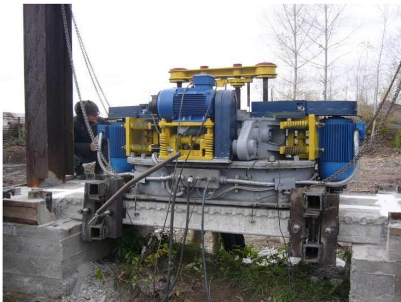
Рисунок 3 – Вибромашина ВИД-12/08М (общий вид при установке на конструкцию)
