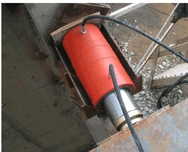
Рисунок 2 – Общий вид силового цилиндра ЦС200Г250
